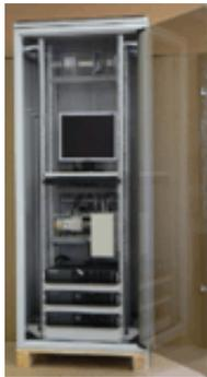
Телемеханический пункт управления МТК-30.ПУ представляет собой программно-аппаратный комплекс, предназначенный для работы в составе автоматизированных систем диспетчерского управления (АСДУ) в качестве устройства приема, обработки и передачи телемеханической информации от устройств телемеханики КП или других ПУ, установленных на диспетчерских пунктах.
