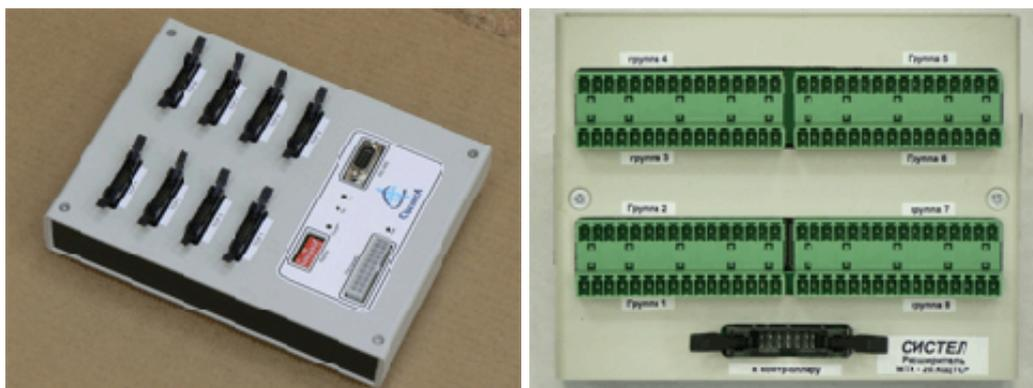
Устройство МТК-20.КЩТС-8 предназначено для вывода информации о состоянии ТС при использовании индикаторов щита (светодиодов), подключенных непосредственно к устройству, либо через расширители. К одному устройству можно подключить до восьми расширителей. Конструкции устройств отличаются разъемами для подключения. Наибольший интерес представляют устройства с расширителями - для них возможно большее количество подключаемых индикаторов щита.
